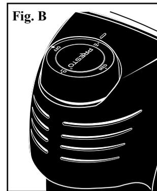
Au réglage le plus élevé, l'élément fonctionne à 100 % du temps. Au réglage le plus bas, l'élément passe automatiquement de mise en marche à arrêt pour produire une quantité moindre de chaleur. Plus le réglage est bas, plus l'élément chauffant reste arrêté pendant le cycle. Ceci est normal.
